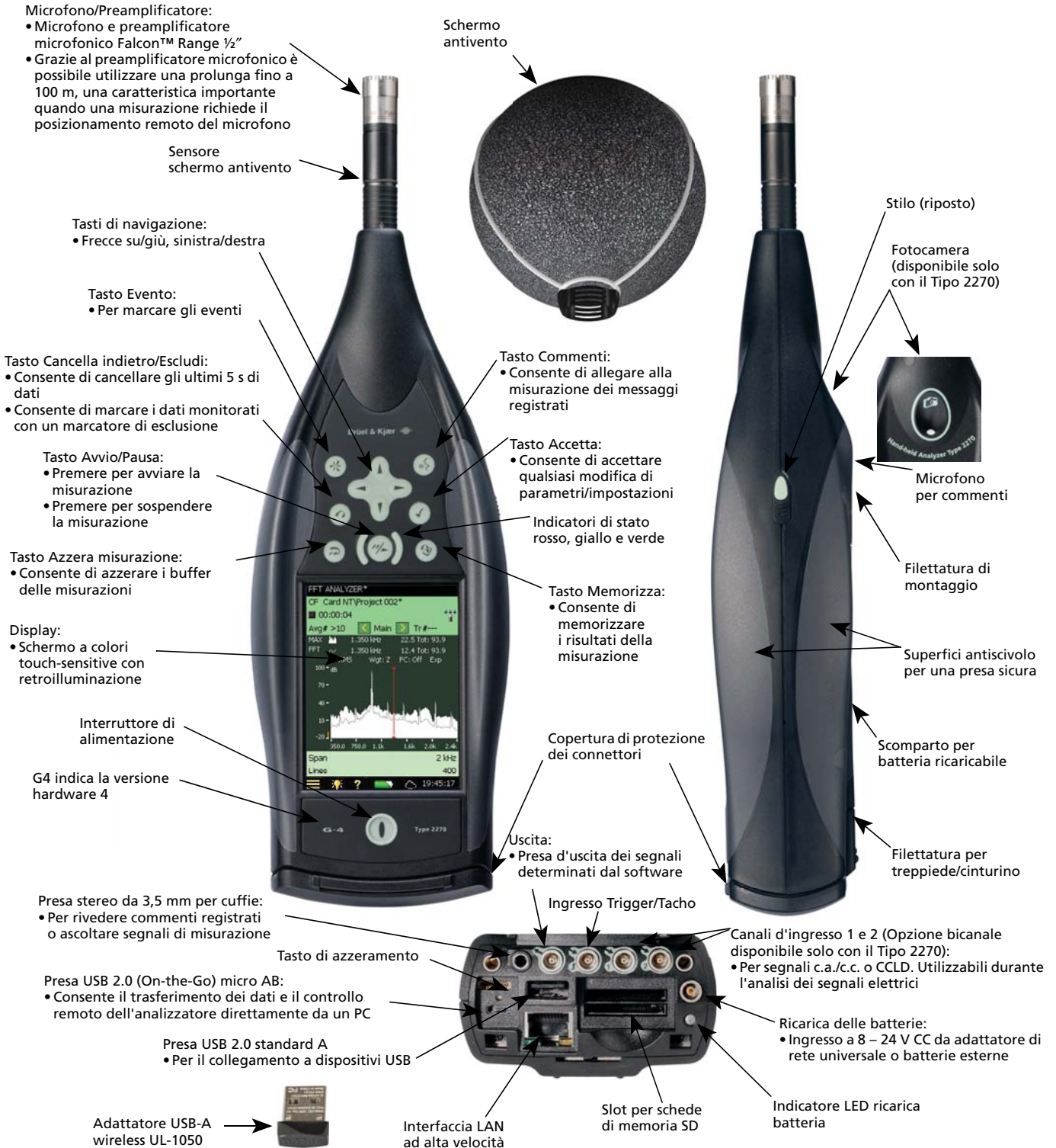
Fig. 1 Caratteristiche principali degli Analizzatori portatili Tipi 2250 e 2270
